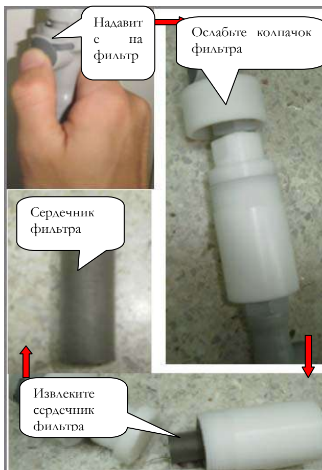
Figure 16.6 Снимите сердечник фильтра деионизированной воды
