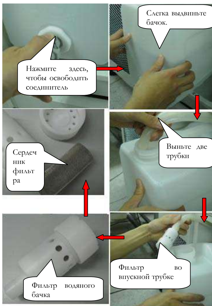
Figure 16.7 Извлеките сердечник фильтра бачка деионизированной воды
