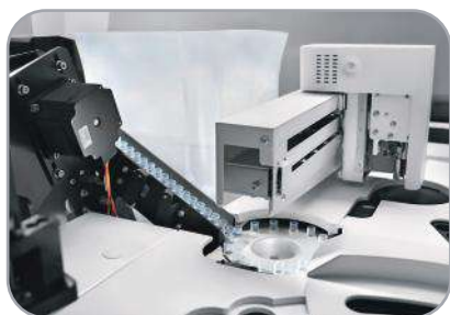
Уникальная конструкция буферной зоны кювет для предотвращения застревания
