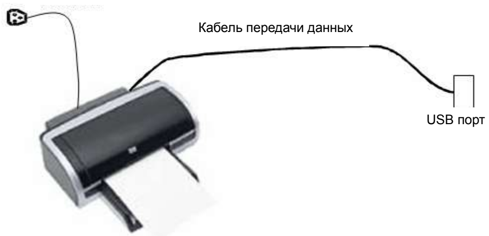
Рисунок 1-3 Подключение внешнего принтера Электрический шнур
